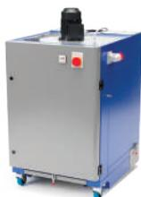
Il filtro carrellato è dotato di 2 filtri a cartuccia orizzontale per l'aspirazione e filtrazione fumi di saldatura, gas, vapori, aerosol, polveri leggere e pesanti e trucioli. Pulizia automatica delle cartucce tramite sistema ad aria compressa.
