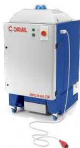
Il filtro carrellato certificato IFA W3 è dotato di 2 filtri a cartuccia orizzontale per l'aspirazione e filtrazione di fumi generati dalle saldature di acciai alto legati, dando una massima efficienza di filtrazione superiore al 99%. Pulizia automatica delle cartucce tramite sistema ad aria compressa.
