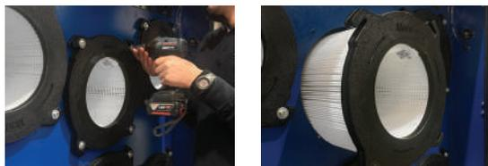
La disposizione orizzontale delle cartucce permette un agevole accesso ed una rapida manutenzione della sezione filtrante.
