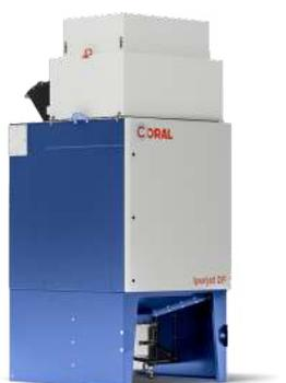
Completo di cartucce orizzontali antistatiche IFA/BGIA M PES/AX EXAM accredited, box insonorizzato e filtro HEPA, Indoor-vent sistema di sfogo dell'esplosione, sistema di pulizia ad aria compressa, quadro elettrico separato dalla macchina con 5 mt di cavo pre cablato, bobina e cavo matrix ATEX, ingresso maggiorato con sistema spegni scintille, motore ATEX, con tramoggia unica e bidone di raccolta che consente un facile e rapido scarico delle polveri filtrate sistema di controllo esplosione.
