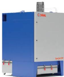
Completo di cartucce orizzontali antistatiche IFA/BGIA M PES/AX EXAM accredited, pannello di sfogo venting, sistema di pulizia ad aria compressa, quadro elettrico separato dalla macchina con 5 mt di cavo pre cablato, bobina e cavo matrix ATEX, ingresso maggiorato con sistema spegni scintille, motore ATEX, doppio cassetto raccolta polveri rinforzato con griglia di separazione polveri bidone anteriore. È consigliabile proteggerlo dagli agenti atmosferici.
