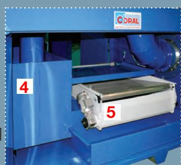
conditions de propreté. Ce système permet d'avoir une installation fonctionnant de façon optimale en permanence et dans le temps. Enfin, à l'intérieur du chassis insonorisé on trouve, le motoventilateur, le système de gestion hydraulique et le filtre pour le traitement de l'eau en circulation. L'armoire de pilotage de tout le système est positionnée sur la machine.
